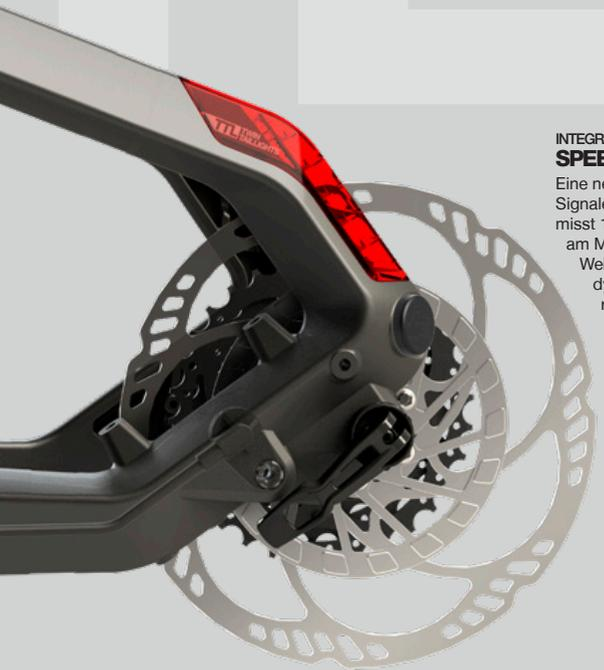
Eine neu entwickelte Speed Sensor Disc 18 Signale pro Radumdrehung an das System und misst 18-mal genauer als alle anderen Systeme am Markt die aktuelle Geschwindigkeit. Auf diese Weise kann das System deutlich schneller und dynamischer auf wechselnde Anforderungen reagieren und erkennt Beschleunigungen bereits bei geringsten Radbewegungen beispielsweise bei Anfahrten am Berg. Der Sensor selbst sitzt an geschützter Position und ausfallsicher integriert im linken Rahmen-Ausfallende.
